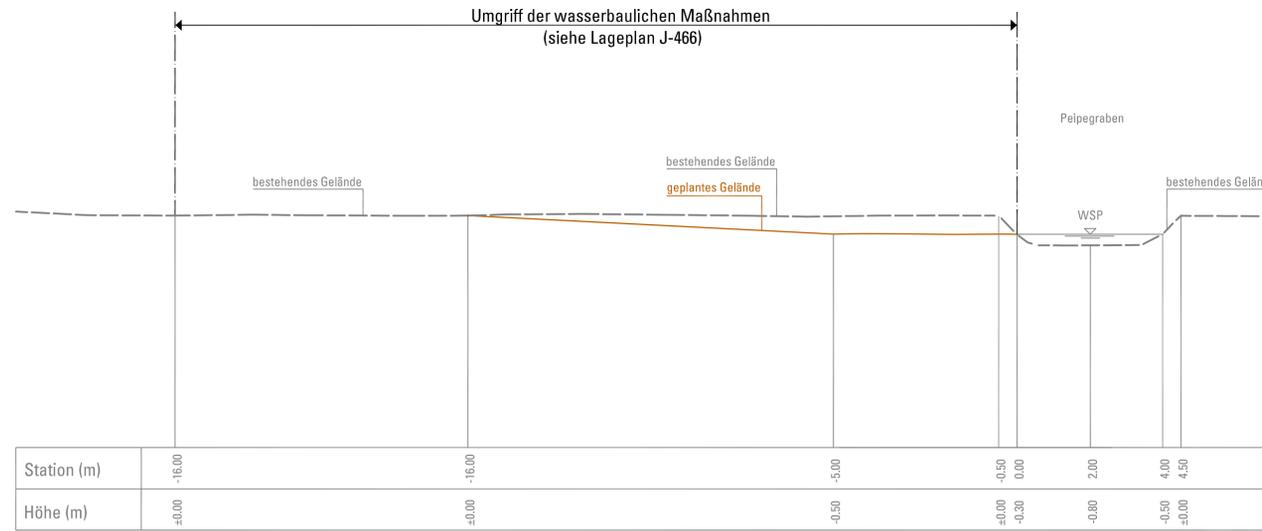
Regelquerschnitt im Bereich 0 + 301 m
